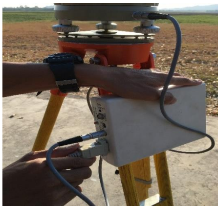
กล่องอินเทอร์เฟซ และสายเชื่อมต่อระหว่างกล่องอินเทอร์เฟซกับตัวกล้อง (สายสีเทา)
