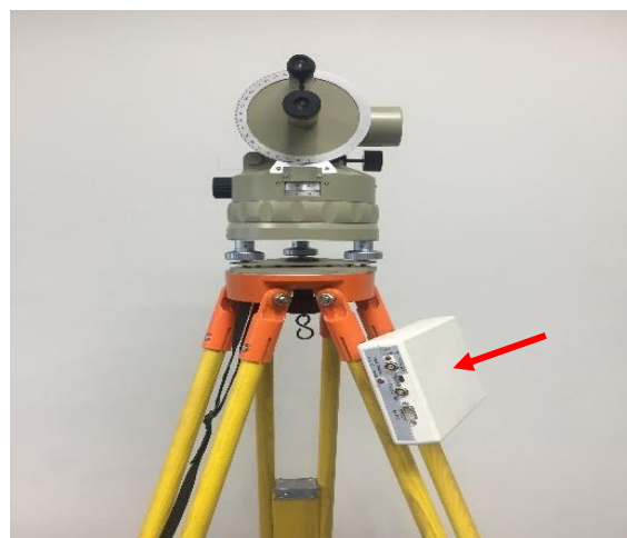
นำกล่องอินเทอร์เฟซมาติดตั้งเข้ากับขากล้อง
